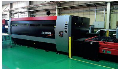
3軸リニアドライブ・ファイバーレーザーマシン
