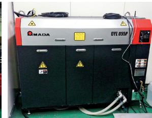
YAGレーザー溶接機
